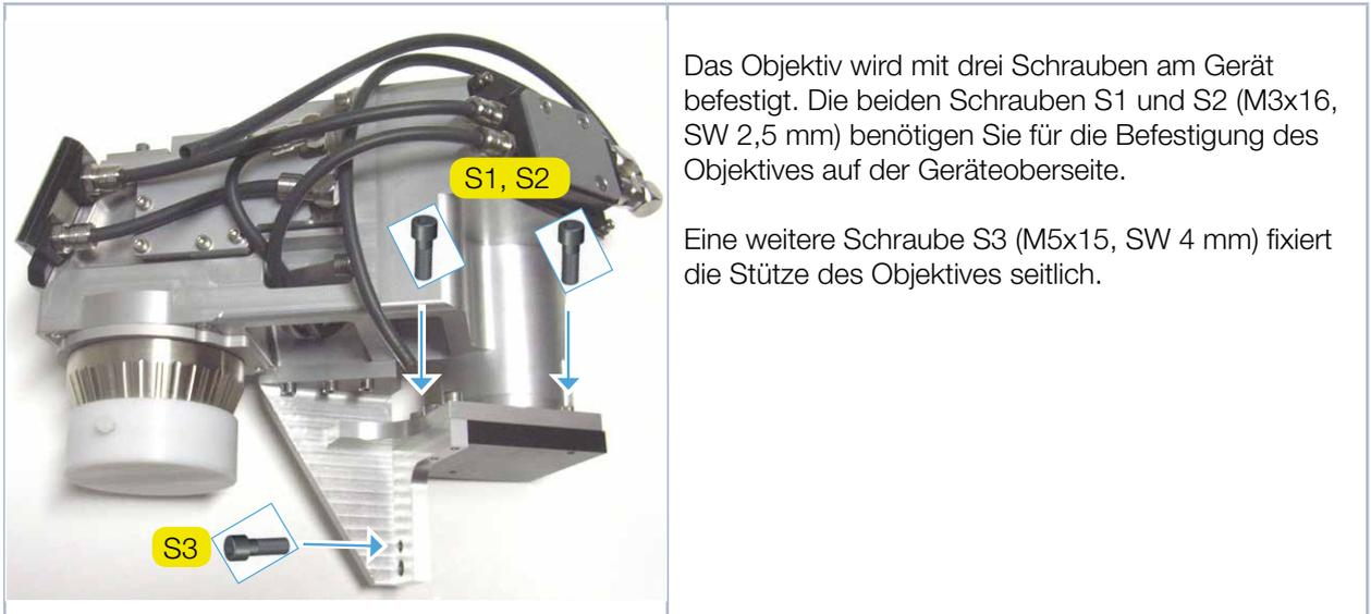
Das Objektiv wird mit drei Schrauben am Gerät befestigt. Die beiden Schrauben S1 und S2 (M3x16, SW 2,5 mm) benötigen Sie für die Befestigung des Objektivs auf der Geräteoberseite.
