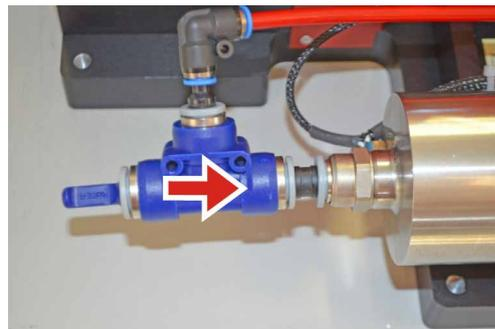
Die Anschlüsse am HP-MSM-HB sind für PE-Schläuche mit einem Durchmesser von 12 mm (bzw. 16 mm beim HP-MSM-HB 20 kW) vorgesehen. Schließen Sie den Kühlkreisvorlauf und -rücklauf an die Wasserver- sorgung an und prüfen Sie, ob die Schlauchverbindungen dicht sind.
